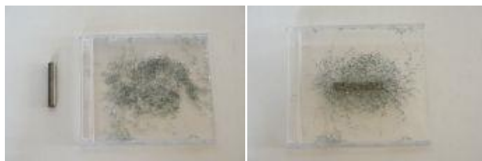
Zdjęcie 1. Magnes i opiłki. Badanie pola magnetycznego za pomocą opiłków.
